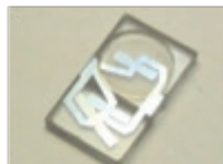
Capteur autonome de pression et température réalisé en partenariat avec la société Schrader
